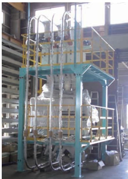
吸引式空気輸送装置例 (左:全体、右:エアー抜き用バグフィルタ)
