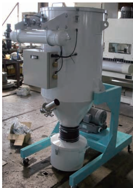
吸引式空気輸送装置例 (左:全体、右:エアー抜き用バグフィルタ)
